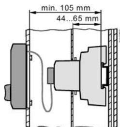
Пульт управления вставляется в отверстие в передней панели (двери) шкафа управления (размеры отверстия см. раздел "Размеры").
