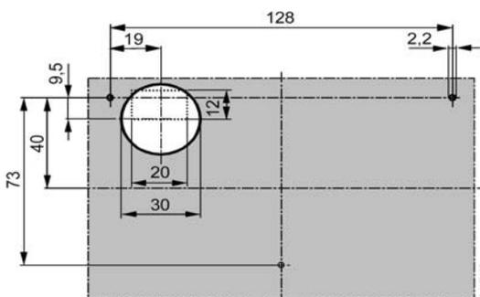
Разметка отверстия в передней панели (с контроллером, установленным на задней стороне)
