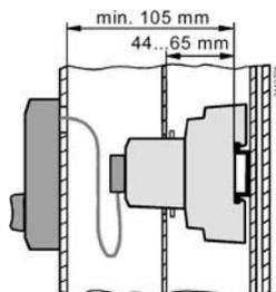
Пульт управления крепится к передней панели (двери) шкафа управления; контроллер устанавливается внутри шкафа управления.
