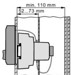
Пульт управления вставляется в отверстие в передней панели (двери) шкафа управления; контроллер крепится с задней стороны двери шкафа управления.
